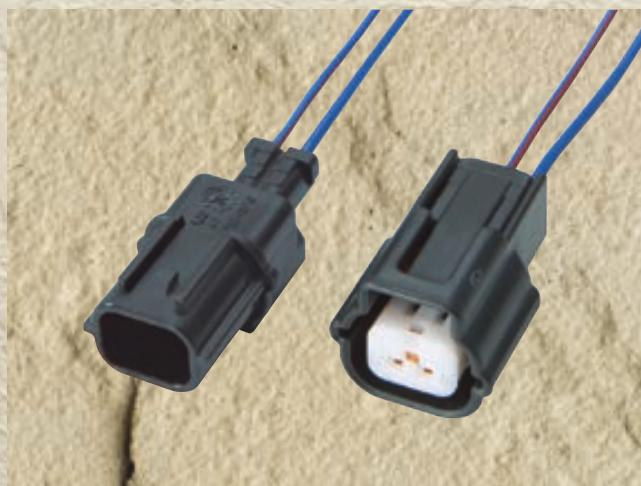
従来の防水コネクタと比べ、優れた防水性能を有し、特殊構造フロントホルダを採用した0.64mmタブサイズ（ピッチ3.0）の超小型防水コネクタです。
